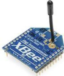
Figura 3. Módulo xbee serie 1
